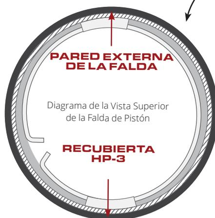
*"La recubierta con HP-3 reduce drásticamente la fricción y permite tolerancias reducidas entre el pistón y la pared del cilindro."*
